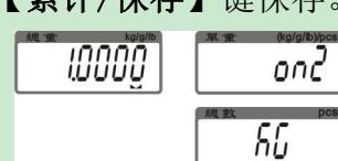
6) 任意选择后面的校正点。如已经在 1kg 处校正好，再加放 500g 砝码，显示窗口会自动显示 1.5000kg。此时再按【扣重/▶】键，完成第二点校正后，窗口显示：
